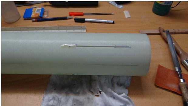
Así mismo procedo a rellenar la parte delantera que sobra de los slots para la longitud de la raíz actual, rellenando los huecos con pequeñas tiras de la fibra cortada y pegándolo con epoxy. Posteriormente se lija alisándolos.
