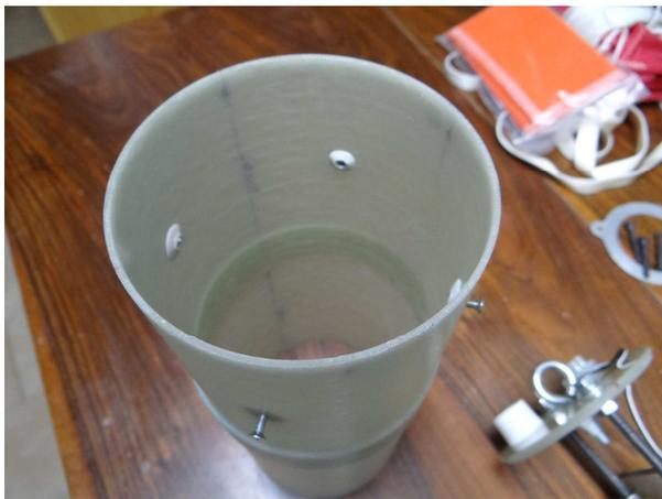
Procedo ahora a ajustar la situación del soporte de electrónica, teniendo en cuenta que el interruptor tiene que ser accesible desde el orificio que hice para la equilibrar la presión barométrica.
