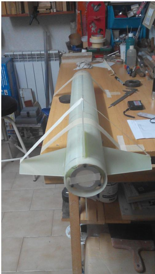
Las otras dos aletas perpendiculares a esta las pego buscando esa perpendicularidad a base de un sistema de medición y tensión desde las aletas anteriores pegadas.
