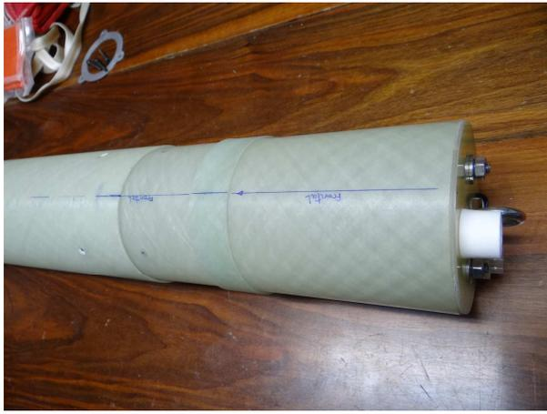
Centrado en el tubo de la bahía electrónica pego la pequeña sección de tubo externo de fuselaje con epoxy, que va servir de tope del fuselaje inferior y a su vez empuje del superior.
