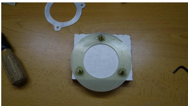
Preparé un útil sobre una pieza de madera para asegurar la perpendicularidad de dichas tuercas mientras fraguaba el epoxy.
