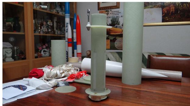
Hembrilla para cordón de fijación sujeta con tuercas, arandela de presión y asegurado con masilla epoxy al anillo de centrado delantero. Pegado del anillo al portamotor con epoxy. El posterior no lo pegó aún.
