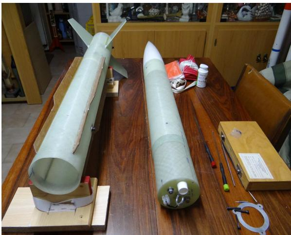
Presentación del fuselaje inferior con sus dos juegos de aletas y del superior con la Ojiva y la Bahía electrónica acoplada.
