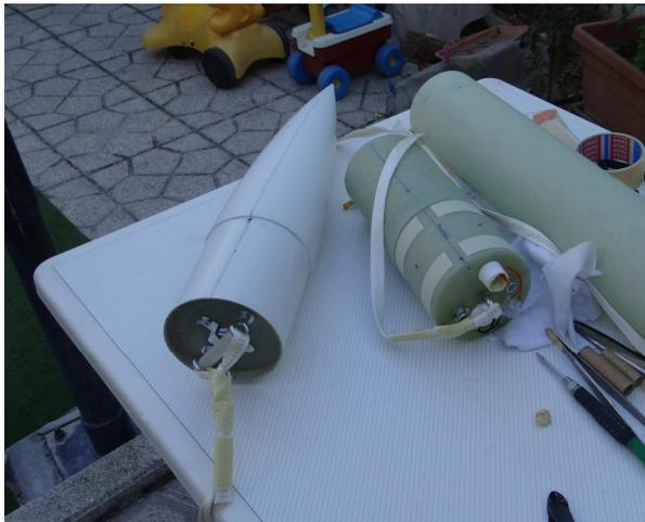
Realizo una prueba estática de eyección de la Ojiva, ya que va asegurada con tres pequeños tornillos de plástico (shear pins) de  $\varnothing$  2,2 mm que alojé en sendos taladros roscados equidistantes alrededor del cuello de la Ojiva.
