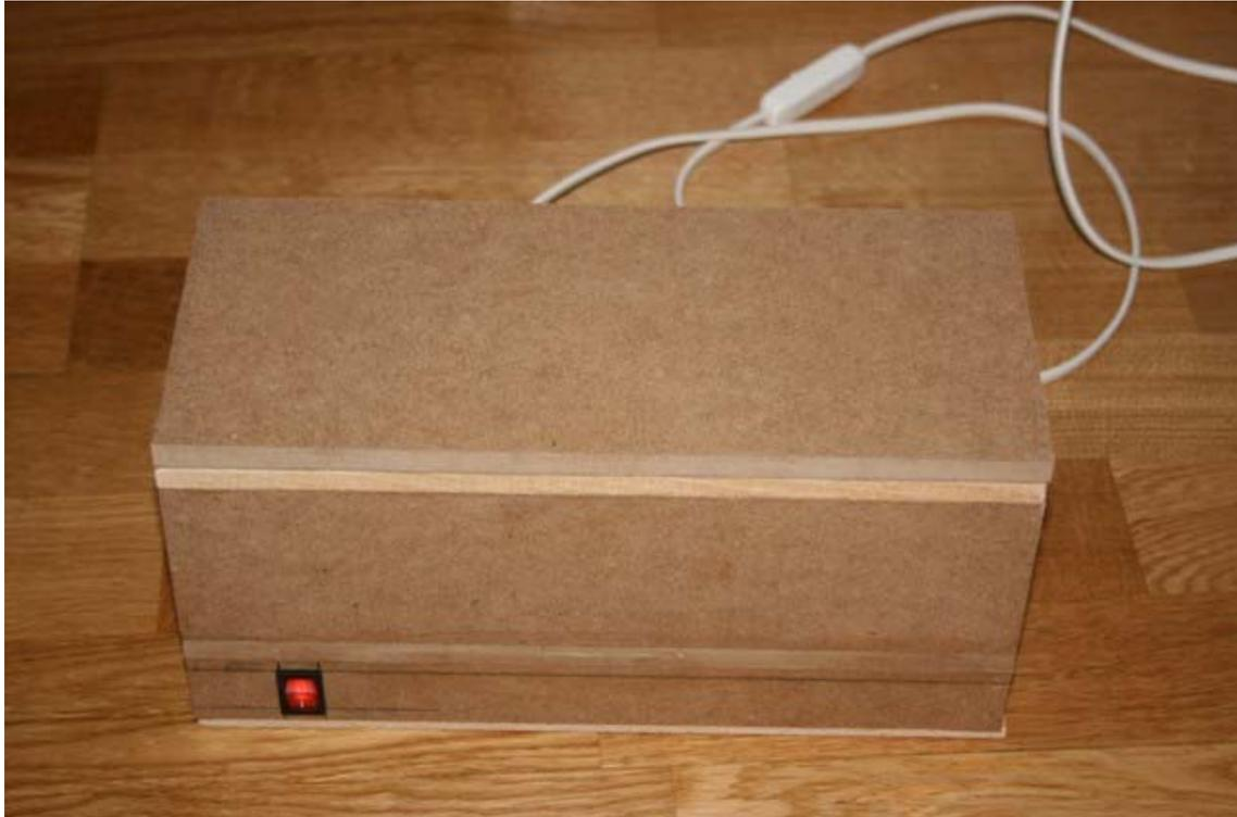
La insoladota cerrada. La parte superior es la tapa con el cristal debajo. Se utiliza un interruptor luminoso ya que el ambiente de trabajo debe ser oscuro.
