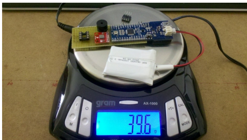
Fig1. Montaje definitivo del proyecto. Se puede ver la placa microcontroladora (azul), placa del sensor altimétrico (rojo), dispositivo acústico (negro), batería (blanco) y placa PCB sobre la que se sueldan los dispositivos (amarillo).
