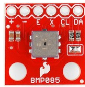
Fig5. Sensor BMP085 montado sobre una placa breakout de Sparkfun. El sensor es la pieza cuadrada central.
