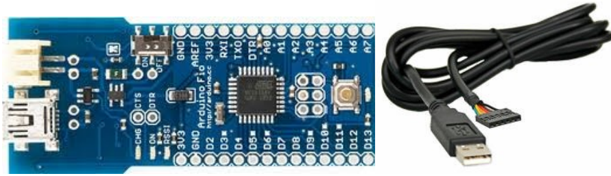
Fig4. Arriba Arduino UNO y cable de alimentación y programación. Abajo, Arduino FIO y cable USB-FTDI de alimentación y programación. En la placa FIO, los 6 pines de arriba a la izquierda son para FTDI (GND-negro, AREF-marrón, 3V3-rojo, RXI-naranja, TXO-amarillo, DTR-verde).
