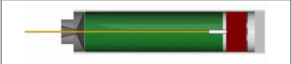
El ignitor se introduce por la tobera hasta alcanzar la cabeza y tocar el retardo.
